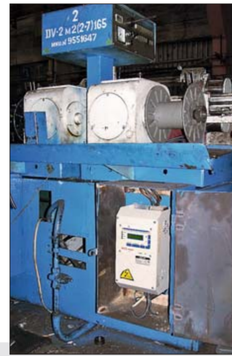
Оборудование «Веспер» используется на Орловском заводе на многих участках. На волочильных станах и канатных машинах преобразователи прячутся в специальных ящиках.
