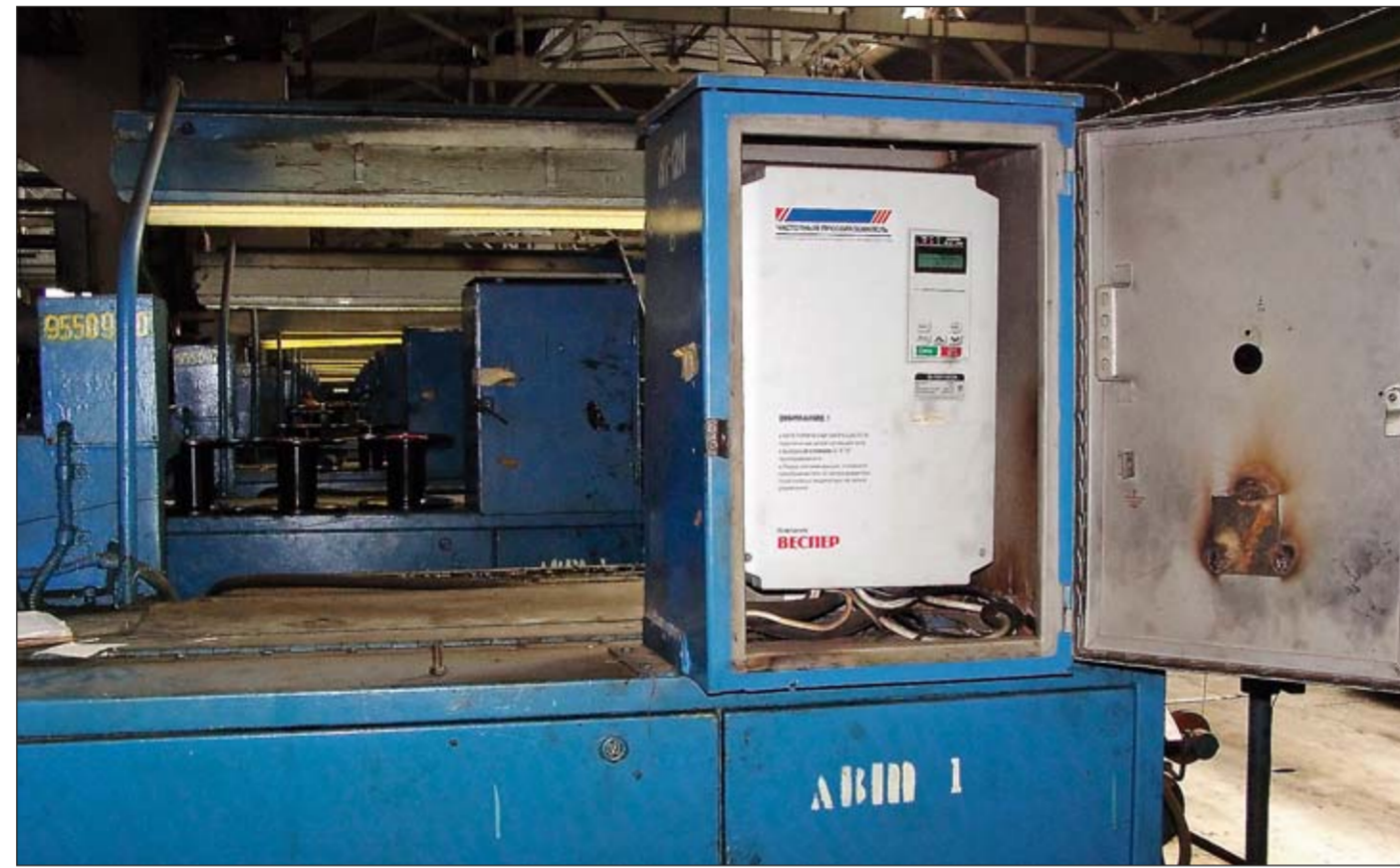
Оборудование «Веспер» используется на Орловском заводе на многих участках. На волочильных станах и канатных машинах преобразователи прячутся в специальных ящиках.
